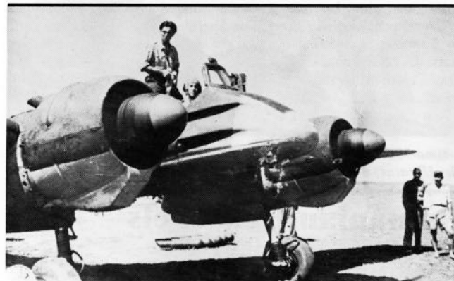
Jiný rumunský Hs 129B-2. Pod trupem jsou patrné pumové závěsníky, za motorem dobře viditelné krátké výfuky (Sbírka C. Bujora)
