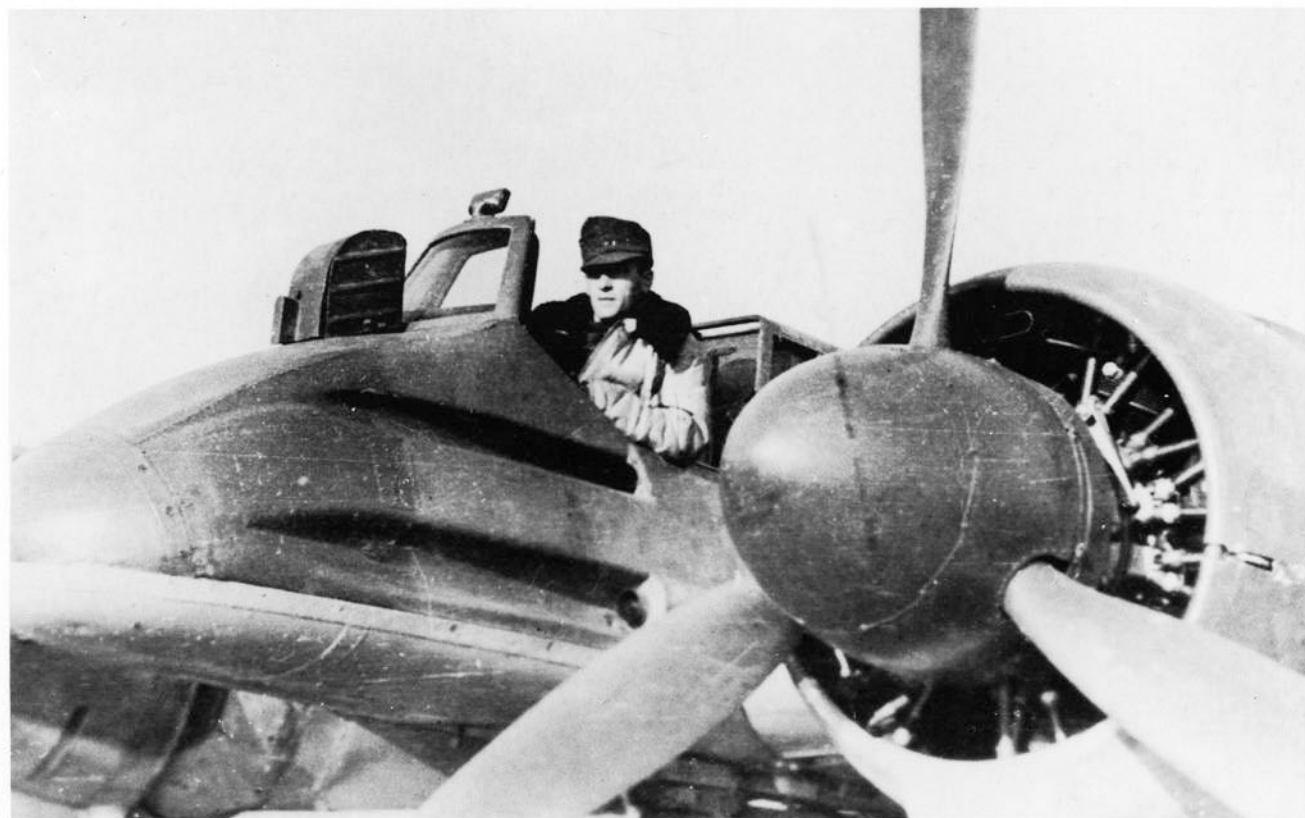
Původně snad fotografie do památníku. Pro dnešního modeláře však dokonalý záběr na výstřelné kanály a kryt zaměřovače Revi (sbírka Constantin Bujor)
