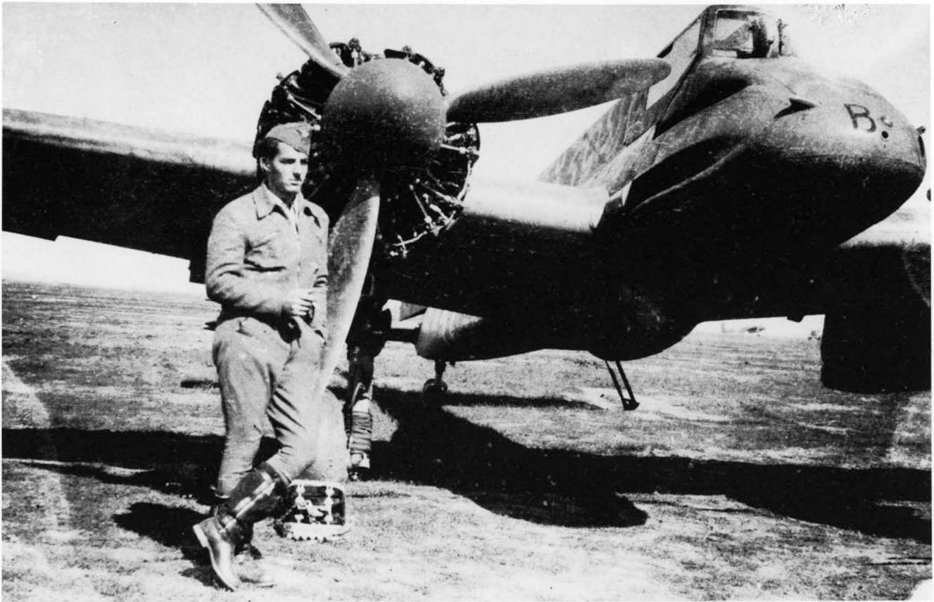
Německý Hs 129B-2 s kanónem MK 101. Na přídí jsou vidět výfuky benzinového topení (ohříváče) (sbírka Constantin Bujor) German Hs 129B-2 with a MK 101 cannon. On the forward nose the two exhaust stacks of petrol heater are visible (C. Bujor Collection)
