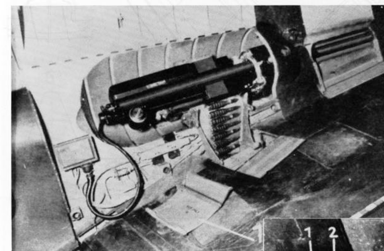
Uložení kanónu MG 151/20 v pravém boku trupu. Přístup ke zbraní umožňovala velká vypouklá odklápěcí kapota (sbírka M. Bílý)
