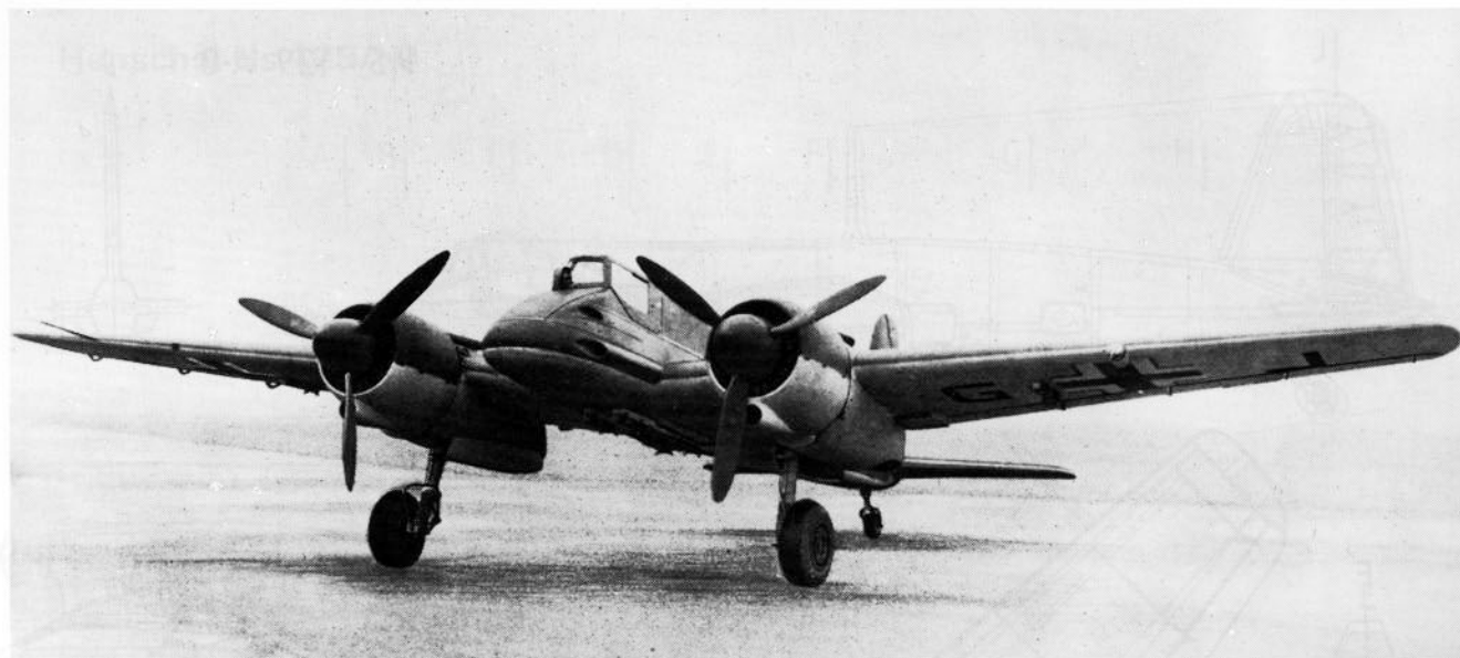
Druhý sériový letoun Hs 129B-1 (Werk Nr. 0152) ještě s krycími plechy přes výstřelné kanály. Na vedlejší stránce je stejný letoun v pohledu odzadu. Dobře viditelné jsou dlouhé výfukové nátrubky (sbírka Martina Velka)
