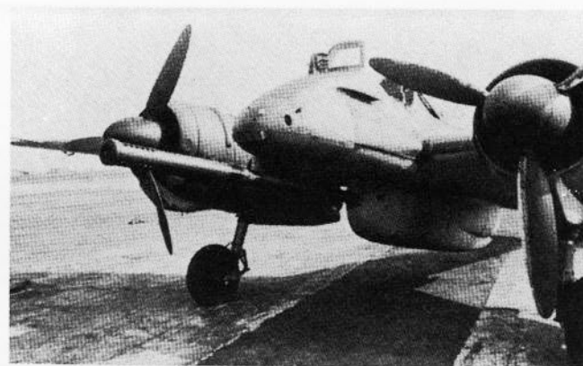
Henschel Hs 129B-3 s kanónem BK 7,5 a zakrytými výstřelnými kanály původních zbraní (sbírka M. Velka)
